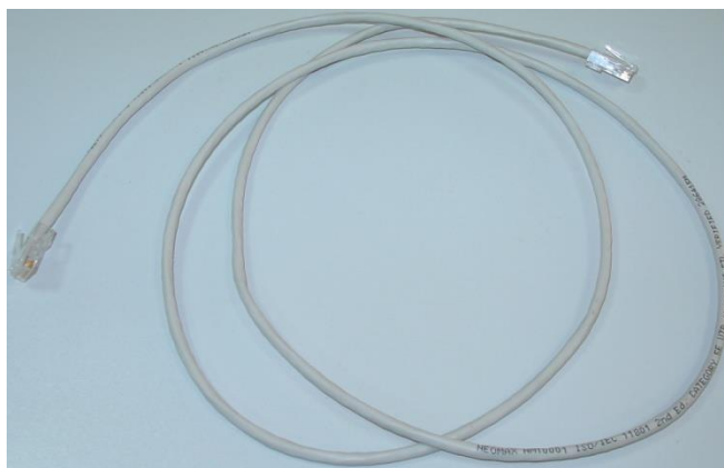
Рисунок 3 Кабель управления выходами ВМп по интерфейсу I2C
