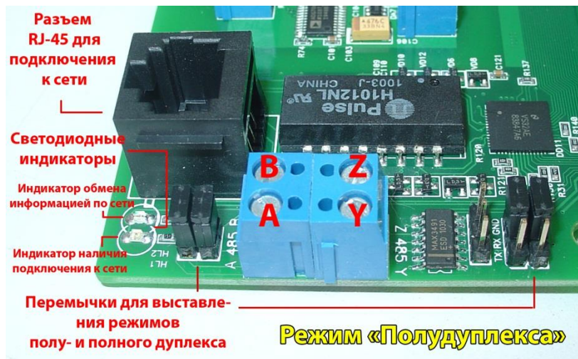
Рисунок 5. Подключение RS-485/422
