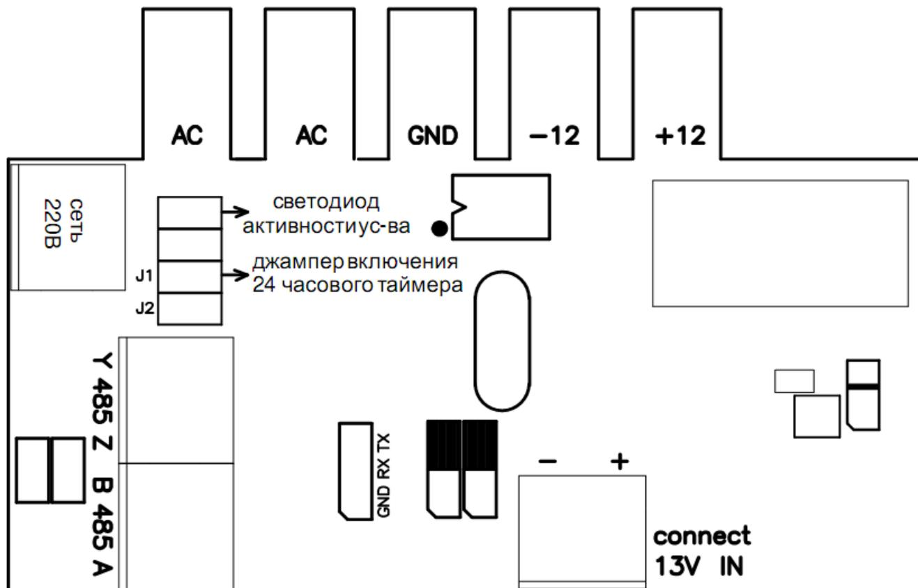
Джампер обозначенный как J1 служит для включения опции 24 часового таймера, т.е. если данный джампер установлен, то с момента включения устройства через каждые 24 часа ААУ будет выполнять принудительный сброс видеоблейзера. Если джампер снят, выше описанная опция отключена.
