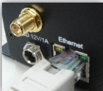
Рисунок 16. Подключение блейзера к видеосерверу (ПК) или к локальной сети
