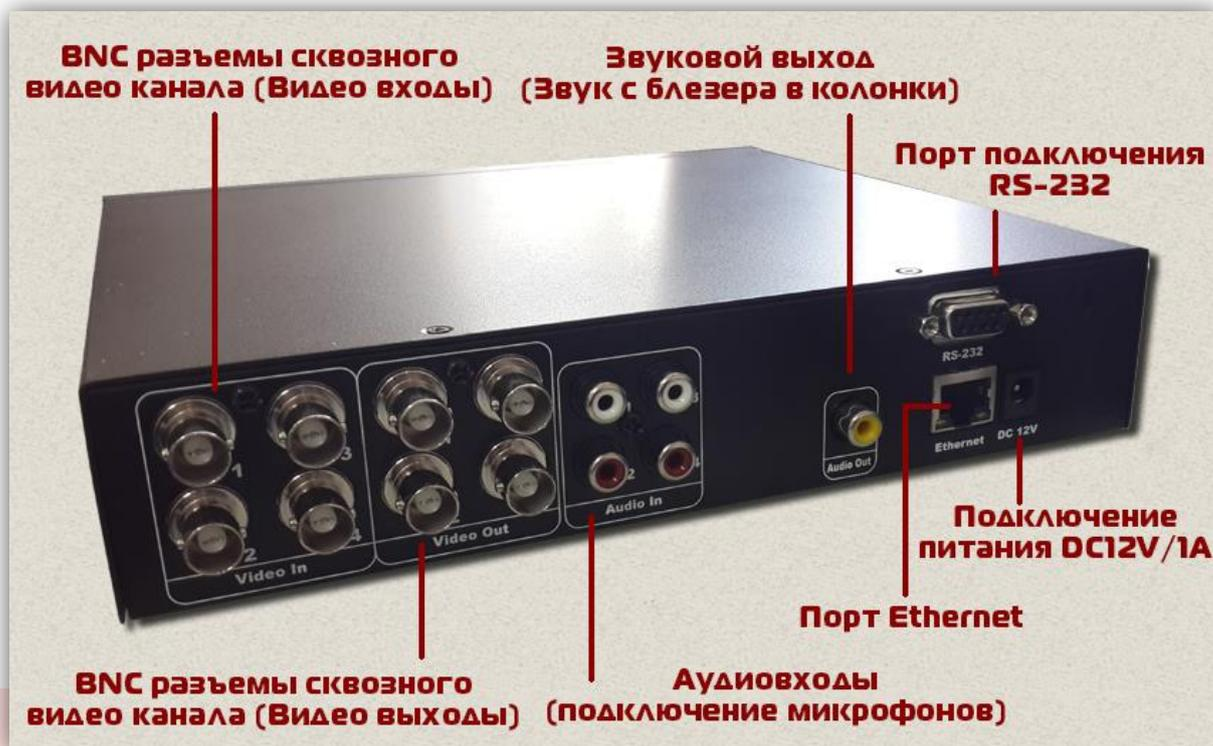
Рисунок 12. Разъемы блейзера. Вид сзади.
