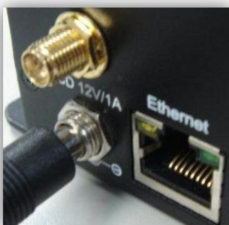
Рисунок 15. Подключение блока питания
