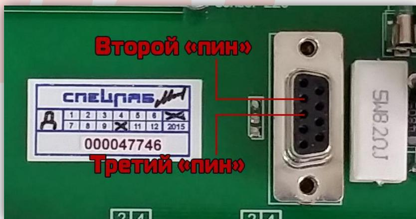
Рисунок 54. Аппаратный сброс к заводским настройкам. Уличное исполнение.
