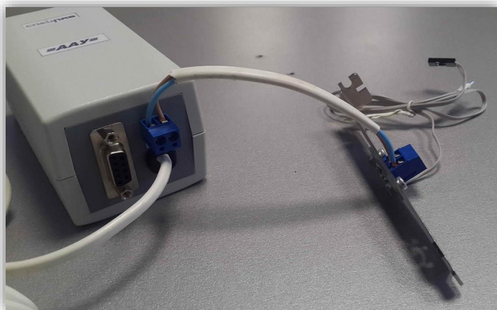
Рисунок 5. Пример подключения блока ААУ к планке в системный блок
