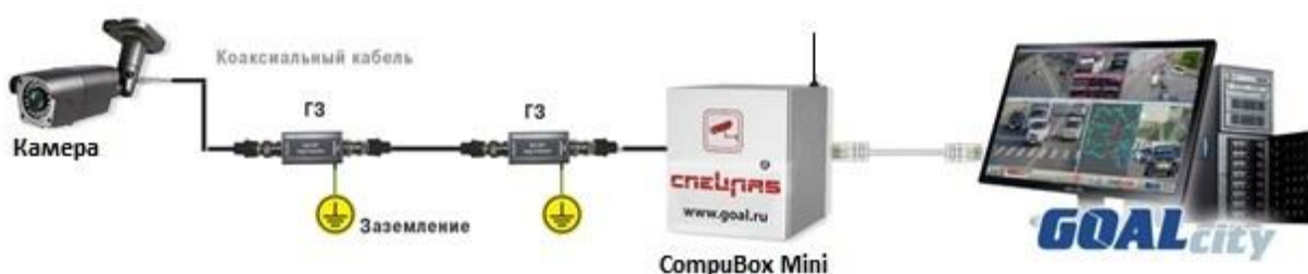
Рисунок 10. Схема подключения и заземления камер
